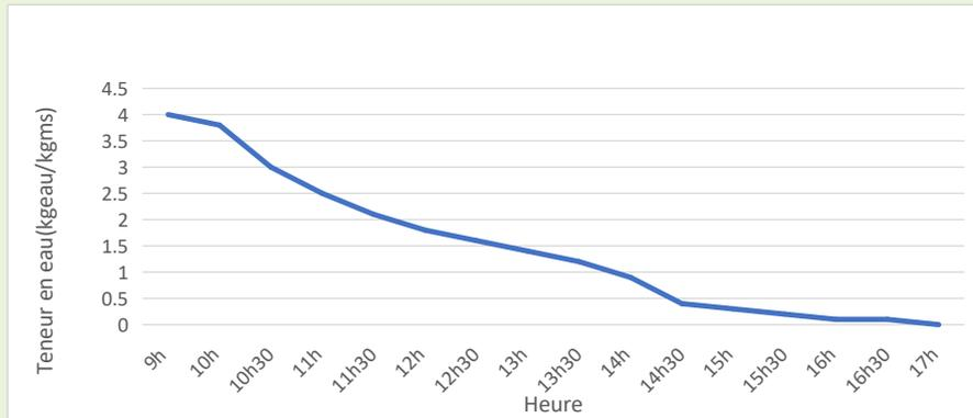
La figure démontre que la durée de séchage de la pomme de terre avec une teneur en eau initial de 4 kg d'eau/kg matière sèche) est de 7h pour ce séchoir solaire indirect sans utilisation de gaz, avec des pics de rayonnement variant entre un maximum de 900W/m<sup>2</sup> de 11h à 13h et un minimum de 350W/m<sup>2</sup> de 16h à 17h.
